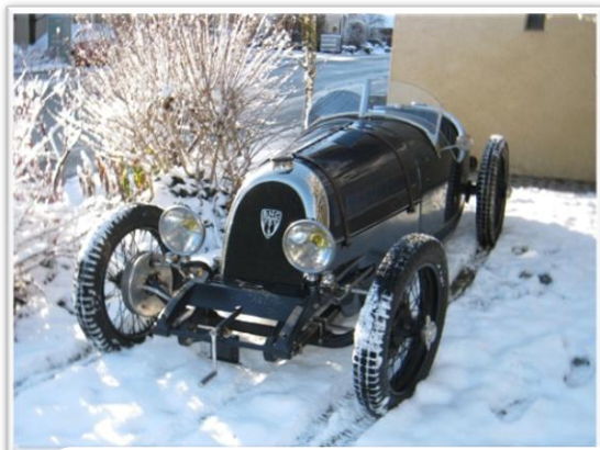
527 type Monza de 1929 , moteur Scap X 11 de 1100 cc avec un compresseur Cozette 7, boîte 4 vitesses, train avant Perrot -Piganot
