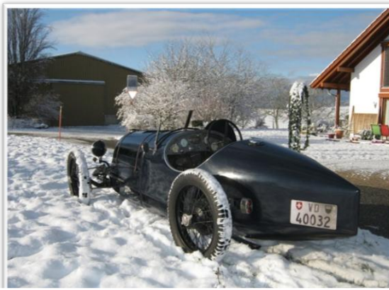
527 type Monza de 1929 , moteur Scap X 11 de 1100 cc avec un compresseur Cozette 7, boîte 4 vitesses, train avant Perrot -Piganot
